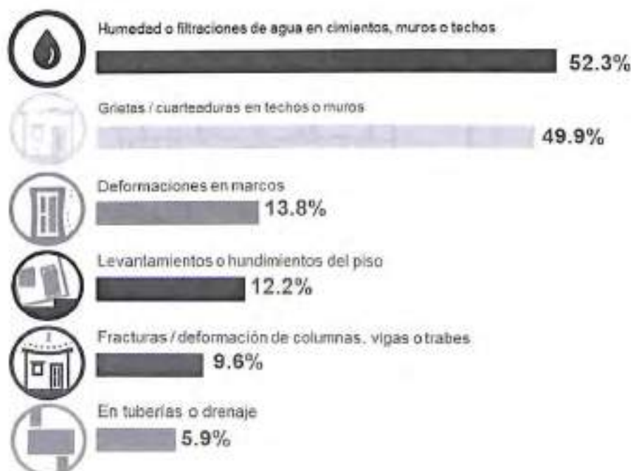
Figura 22. Porcentaje de viviendas particulares habitadas con problemas estructurales.
